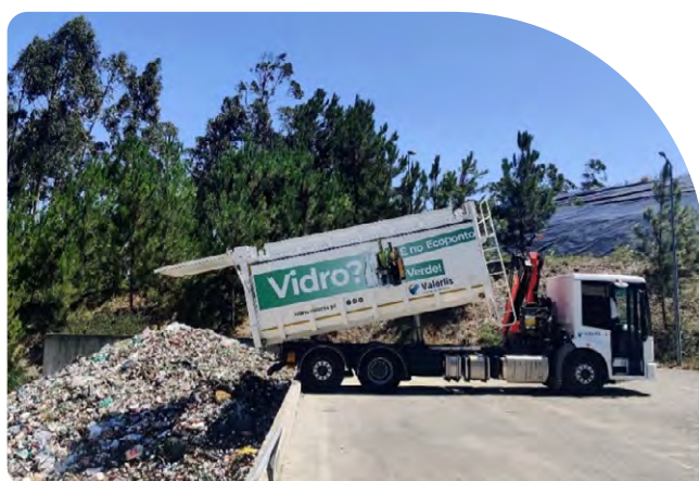
Figura 13 – Descarga de vidro no silo de armazenamento
