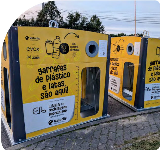
Figura 25 – Contentores protótipo com identificador RFID e leitor de embalagens
