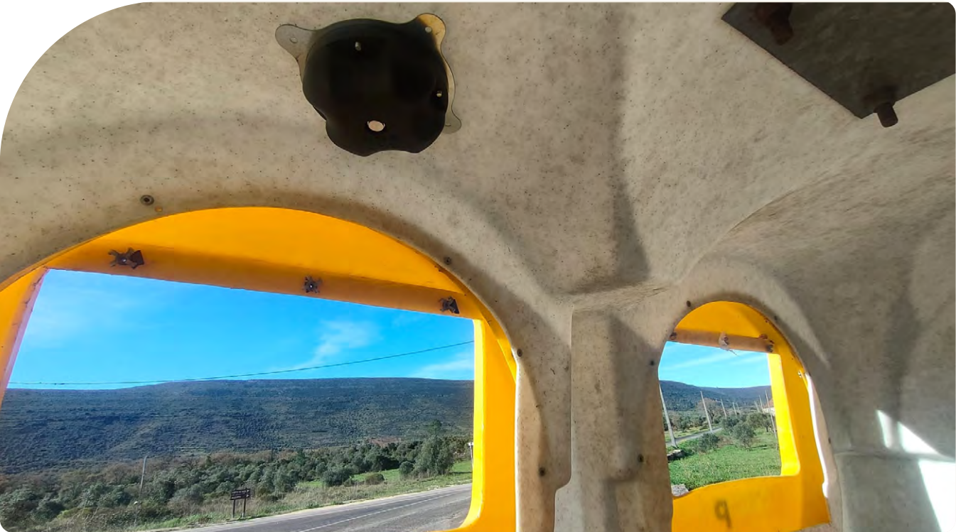
Figura 7 – Contentor equipado com sensor de enchimento
