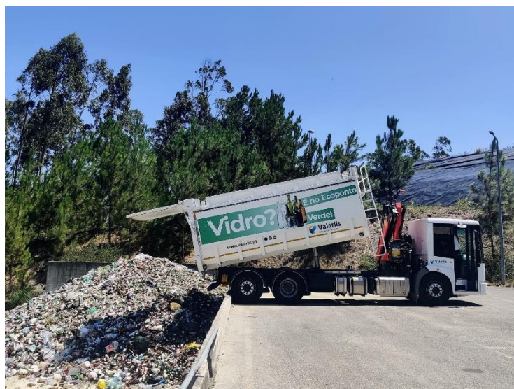
Figura 12 - Descarga de vidro no silo de armazenamento
