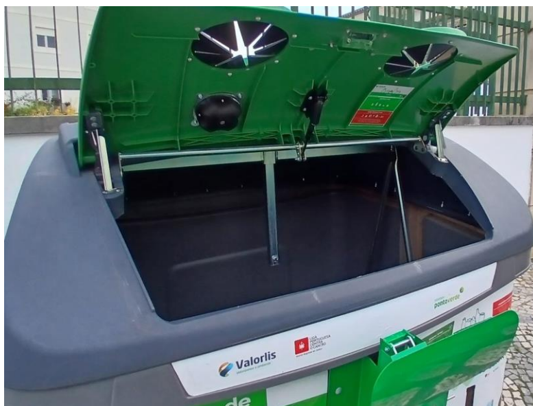
Figura 7 – Contentor equipado com sensor de enchimento
