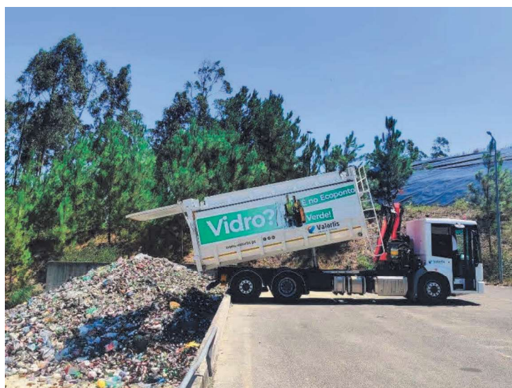
Figura 12 - Descarga de vidro no silo de armazenamento
