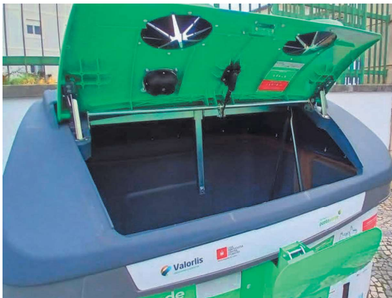
Figura 7 – Contentor equipado com sensor de enchimento
